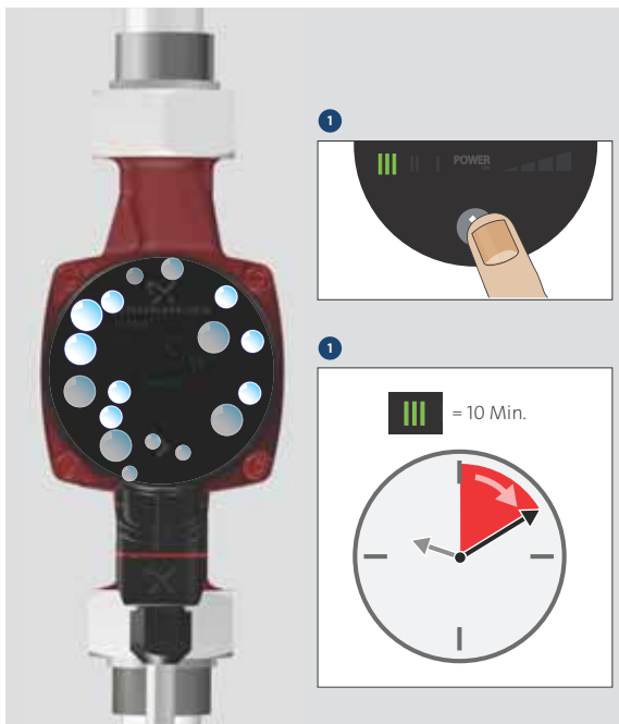
5. ábra A szivattyú légtelenítése
